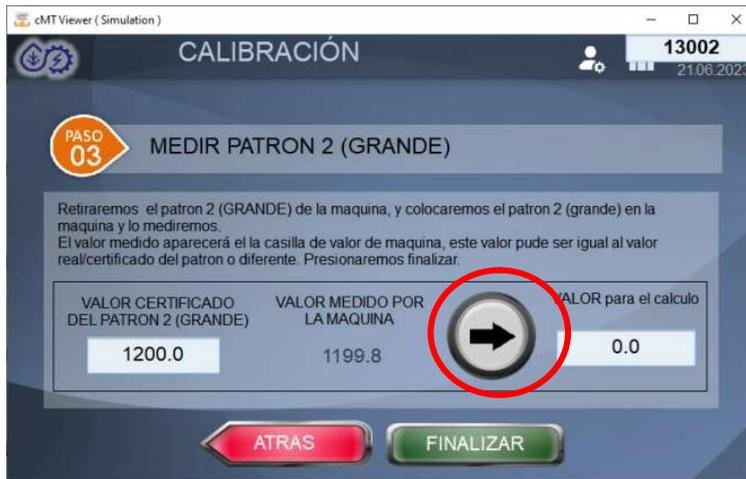
Presionaremos **finalizar** y esta calculará el segundo escalonamiento de la maquina. Ya tendremos la maquina calibrada.
