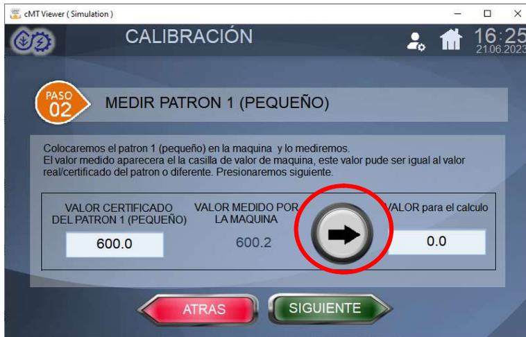
Presionaremos **siguiente/finalizar** y esta calculará el escalonamiento de la maquina. En el caso que solo tengamos un patrón ya habremos acabado el calibrado. En el caso de dos patrones al presionar siguiente nos pasara al paso 3.
