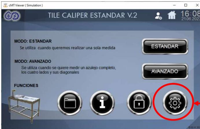
Utilizaremos el asistente de calibración presionando calibrar y seguiremos sus pasos.
